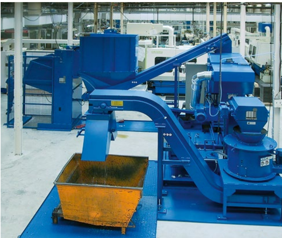
Späneaufbereitungs-Anlage bestehend aus den Komponenten: Zentrifuge, Spänebrecher, Förderer und Containerverladung.
